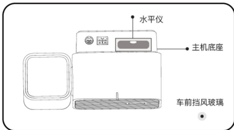
安装时确保水平仪气泡位于中心
